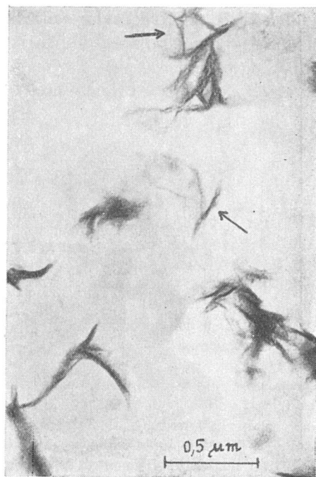
Obr. 2—3. Menšie častice zhlukov mednatého komplexu, zrážaného Fehlingovým roztokom (I + II), s polysacharidmi bukových hemicelulóz. Centrálne tmavšia časť je obklopená svetlejším difúznym plášťom (šípky). Preparát netienený. Orig. EM foto.
