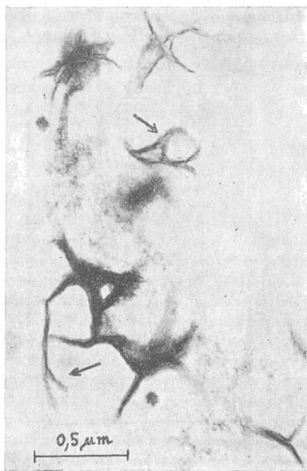
Obr. 2—3. Menšie častice zhlukov mednatého komplexu, zrážaného Fehlingovým roztokom (I + II), s polysacharidmi bukových hemicelulóz. Centrálne tmavšia časť je obklopená svetlejším difúznym plášťom (šípky). Preparát netienený. Orig. EM foto.
